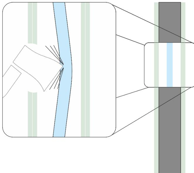
Mit Hinblick auf die extrem unterschiedlichen thermischen Ausdehnungskoeffizienten von Glas und Polycarbonat bietet die schwimmende Lagerung dem Polycarbonat Raum für Ausdehnung, während das Glas im Isolierglassystem bekanntermaßen die Größe beibehalten kann.
