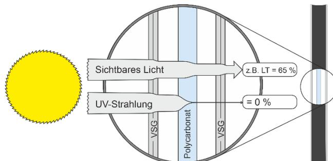
Da das Polycarbonat als mittlere Scheibe nicht gasdicht mit dem Isolierglassystem verbunden ist, kann Gas vom ersten SZR in den zweiten SZR ausweichen und bei Abkühlung wieder zurückströmen.
